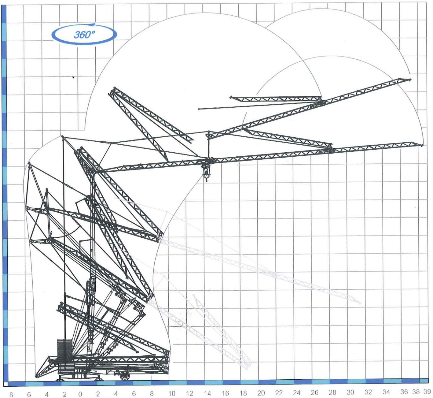
Sequenza di montaggio su 360°. Aufstellvorgang über 360°. Déroulement de montage sur 360°. Erection procedure on 360°. Montaje sobre 360°.
