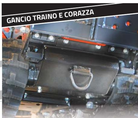
La macchina è dotata di 4 punti di sollevamento omologati per posizionare la macchina in ogni posto oltre a 2 punti per il traino.
