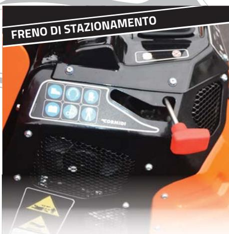
Dotata di un freno di parcheggio per renderla sicura anche in assenza di un operatore esperto, è anche dispositivo di emergenza.
